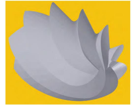
In unsere Schleifssoftware **KIRNER BURRSoft®** ist eine 2D Simulation bereits integriert. Die Nutberechnung in **KIRNER BURRSoft®** erzeugt scharfe Zähne im Bereich des kleinen Radius und einen sehr schönen Übergang in den Bereich des großen Radius.
